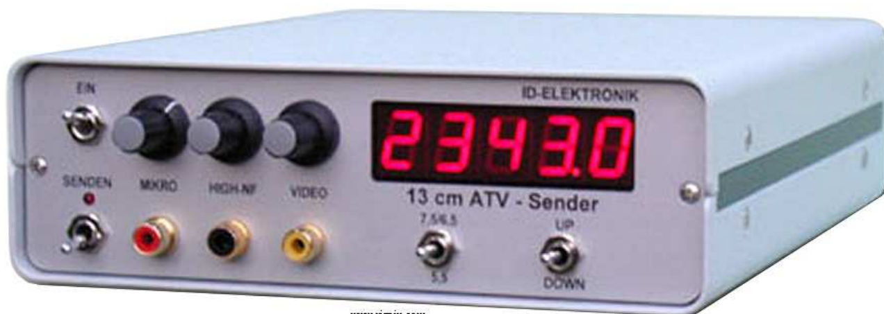
Fot. 6.9. Nadajnik FM-ATV na pasmo 13 cm o mocy 1,5W
