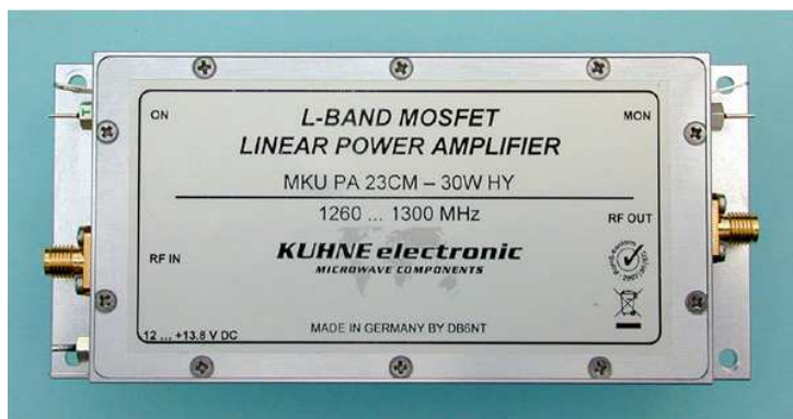
Fot. 3.4. 30-watowy wzmacniacz na zakres 1260 – 1300 MHz
