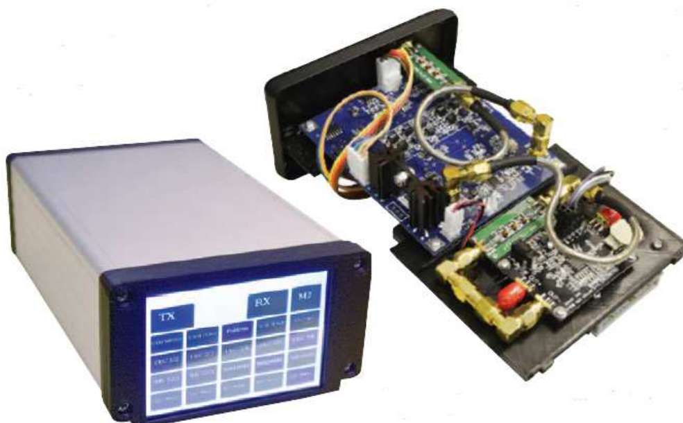
Fot. 2.6. Nadajnik w obudowie i jego konstrukcja wewnętrzna
