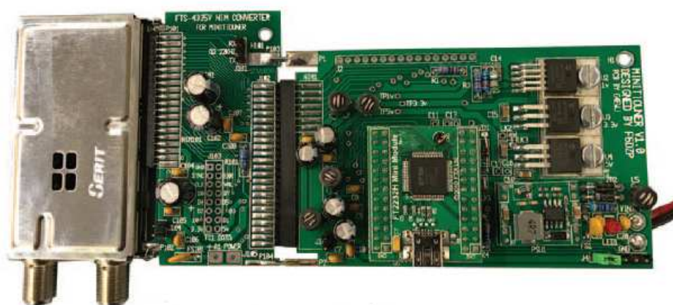
Fot. 2.7. Jeden z wariantów odbiornika „MiniTiouner USB”
